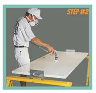
LAY THE DOORS ON SAW-HORSES, SPRAY THE SIDE OF DOOR THAT IS FACING UPWARD & THE EDGE OF THE DOOR THAT IS CLOSEST,
